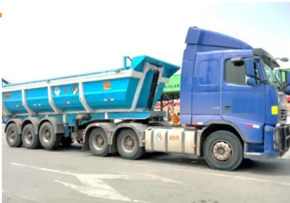
Transporte de Concentrado de Mineral en Tolvas
